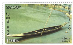
Η πιρόγα κατασκευάζεται συνήθως από μονοκόμματο κορμό δέντρου.
